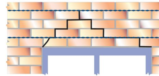
Stabilisierung gekrümmter Wände in Seitenträgern
