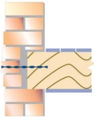
Verbindung von Innen- mit Außenwänden
