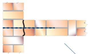
Reparatur von getrenntem Mauerwerk
